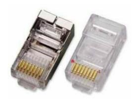
Существует две основные схемы обжима кабелей: Т568A и Т568B, но значительно чаще применяется Т568B. Для соединения компьютер-коммутатор или компьютер-хаб используют прямой кабель, обжатых с обоих сторон одинаково, соединения компьютер-компьютер или коммутатор-коммутатор (хаб-хаб) используют перекрестный кабель (кроссовер, crossover) - с одной строны Т568A, а с другой - Т568B.
