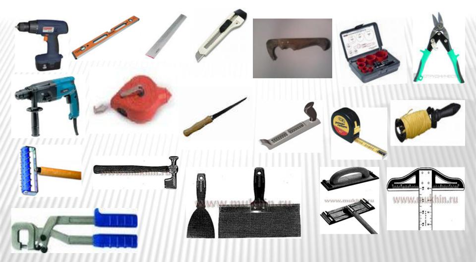
Шуруповерт. Уровень. Правила. Нож. Нож по гипсоволокну. Фреза-набор для вырезания круглых отверстий. Ножницы по металлу. Перфоратор небольшой. Приспособление шнуроотбойное для разметки. Ножовка по гипсокартону. Рубанок- обдирочный для обработки кромки листов гипсокартона. Рулетка. Шнур строительный. Валик игольчатый. Молоток. Пресекатель. Шпатели стальные. Терки. Рейсшина.
