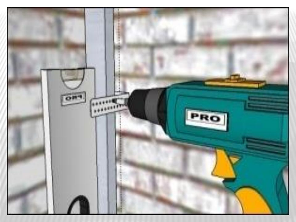
Так же как и на полу закрепляем профиль на потолке.
