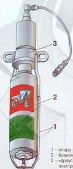
Данное пусковое приспособление используется для облегчения пуска двигателя при низком уровне заряда аккумулятора. Оно позволяет подать напряжение на стартер.
